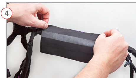
4 Inner adhesive strip is applied to bundle as a starting point, the exterior sealing strip will be facing outside of the sleeve wrap La línea de ayuda de fijación se coloca sobre los circuitos y la línea de sellado deberá de estar posicionada hacia afuera del arnes
